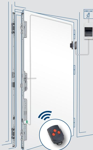
Steuerung und Netzteil zur Hutschienen-Montage im Schaltschrank
