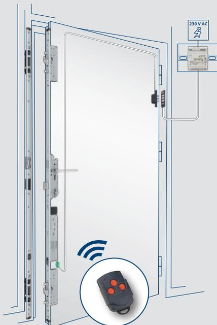
Steuerungsbox mit integriertem Netzteil zur Wandmontage
